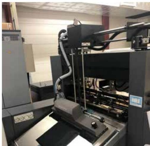
町田印刷では、オフセット枚葉印刷機による冬場印刷時におけるインキ着肉不良を解消する「紙面昇温装置SION」を開発致しました。
